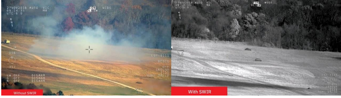
Fotoğraf-8: SWIR Kamera Görüntüsü ( https://www.l3harris.com/swir )
