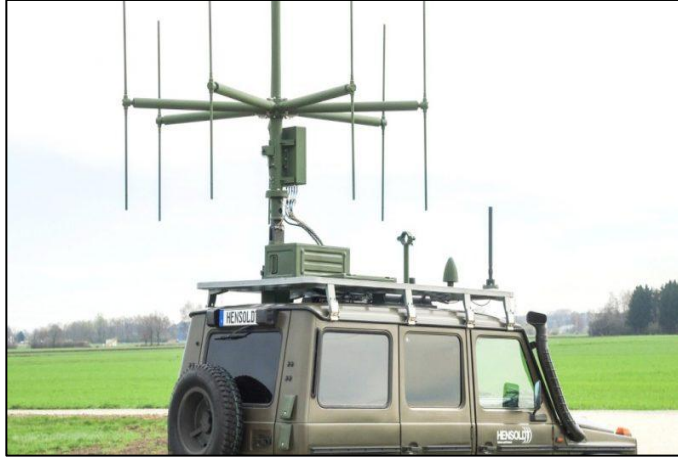
Resim 13: Celldar Pasif Radar Sistemi
