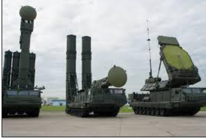
Resim 7: Rus S-300 Hava Savunma Sistemlerinin ilk modellerinde kullanılan darbe doppler radarı
