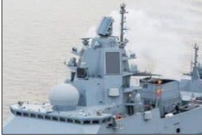
Resim 24: Poliment (Redut) AESA Radarı
