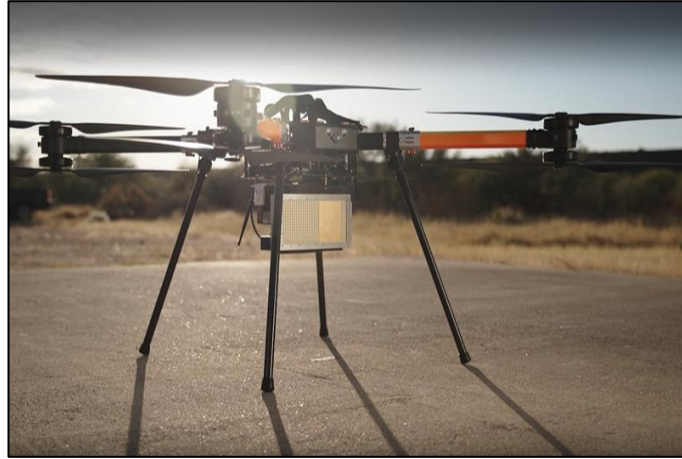
Resim 6: Honeywell IntuVue RDR-84K dron radarı
