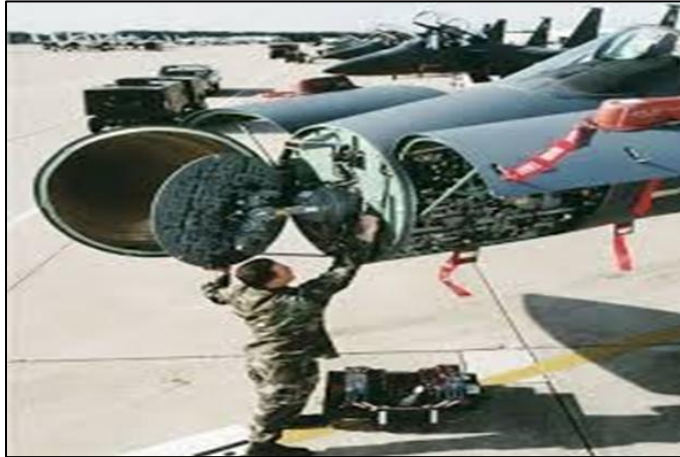
Resim 4: F-15 uçaklarının ilk modellerinde kullanılan APG-63 Radar
