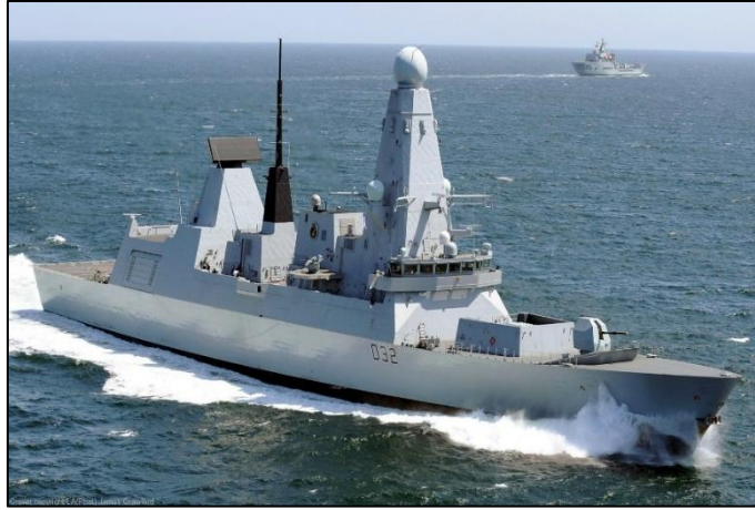
Resim 37: SAMPSON AESA Radarı entegre edilmiş Type 45 Destroyeri
