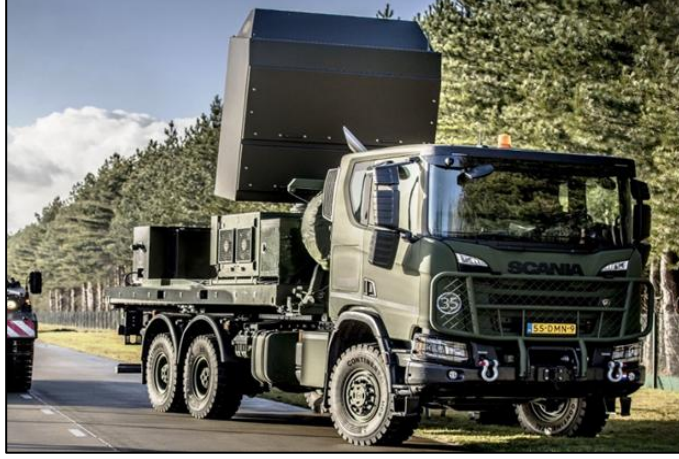
Resim 34: Ground Master AESA Radarı (GM200 Modeli)
